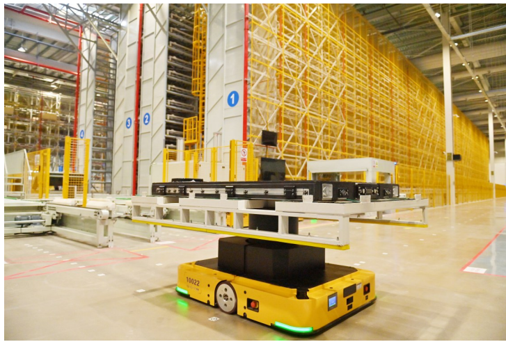
3月14日，吉林省长春国际汽车城的一汽弗迪新能源动力电池项目内，AGV配送车在将电池送入自动放电库。一汽弗迪新能源动力电池项目是东北地区首个新能源汽车电池基地。
