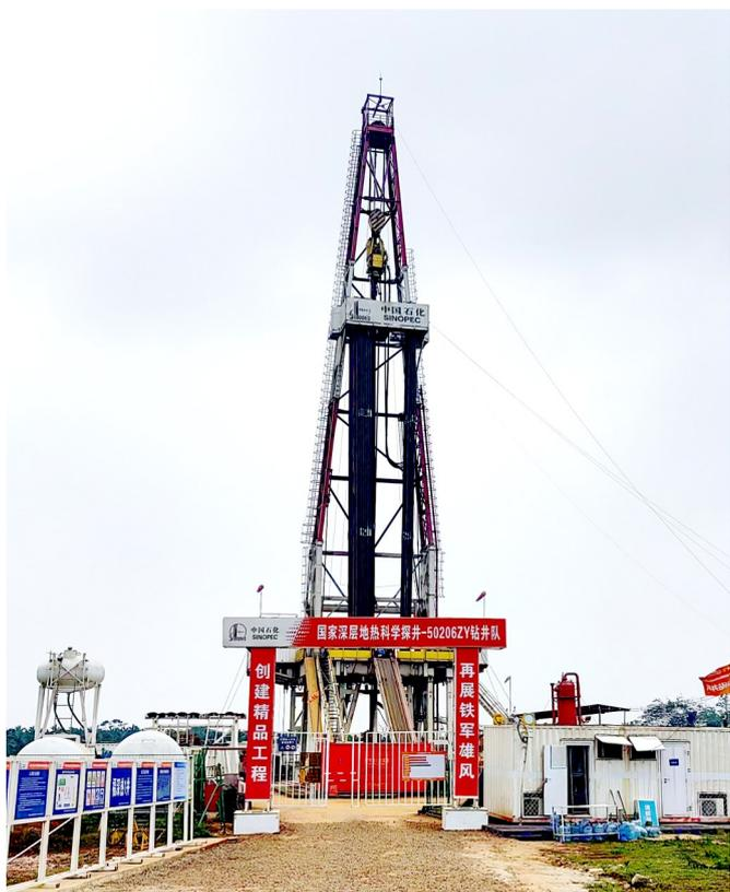
位于海南省海口市的琼北深层地热（干热岩）福深热1科学探井，该井钻探设计井深5000米，是中国目前最深的地热探井。
