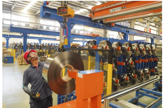
位于山东省青岛市即墨区的青岛云路先进材料科技股份有限公司精装车间内，工人正在吊装非晶薄带。
