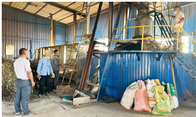
在江西省高安市一农作物秸秆综合利用项目现场，工人将废弃秸秆倒入热解炉。 郑新钰摄
