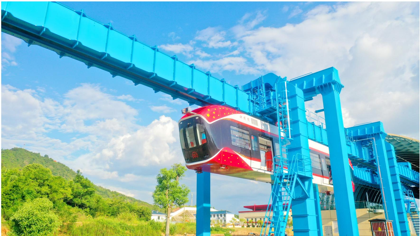
日前,国内首条稀土永磁磁浮轨道交通工程试验线——“红轨”,在江西兴国县竣工,并实现将稀土永磁磁浮技术与空轨技术结合,建成中低速、中低运量的新制式轨道交通系统。“红轨”试验线由江西理工大学牵头,与江西兴国县联合中铁六院、中铁工业、国家稀土功能材料创新中心等单位共同完成。试验线正线全长约800米,均为钢构高架线。磁浮列车采用2车编组,载客能力为座席32个、定员88人,最高设计运行速度为80公里每小时。图为“红轨”试验线列车驶出车站。新华社记者 胡晨欢摄
