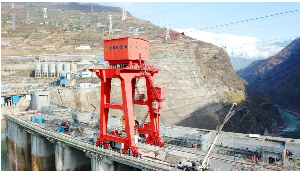
近日,白鹤滩水电站坝顶门机通过负荷试验,标志着全球水电行业单钩起重重量最大的门机具备投运条件。白鹤滩水电站坝顶门机为双向斜拉门式启闭机,起重量为10000千牛/500千牛,布置于坝顶836高程上,其中主钩起重量为10000千牛,为目前全球水电行业单钩起重重量之最。
