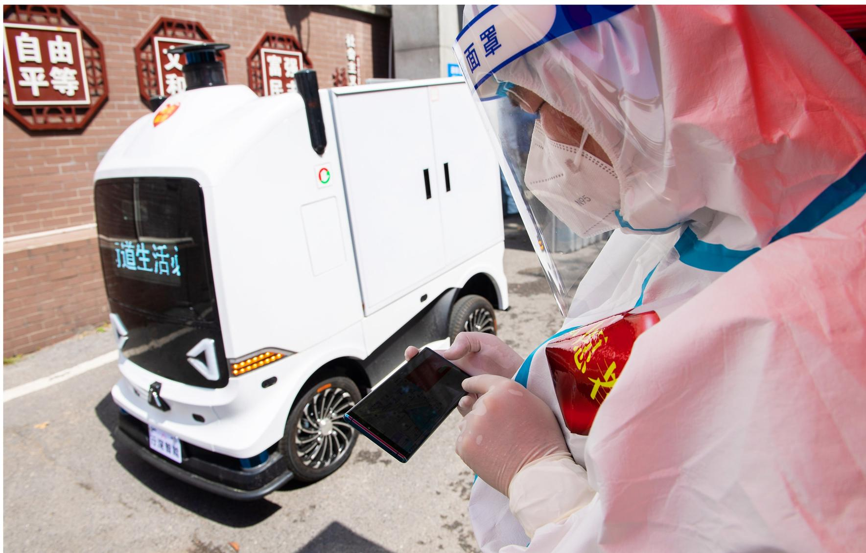
近日,为降低防疫一线工作人员接触感染风险,减轻人工配送压力,湖南省长沙市雨花区东塘街道在防疫封控区投入使用多台无人配送车,为封控区内的居民运送生活物资。该车可设置配送路线,在无人驾驶的情况下将物资从小区门口运输到小区内指定的集中卸货点,再由志愿者为居民逐一配送上门。这样降低了因人员聚集而带来的疫情防控风险,助力解决物资“最后一公里”无接触配送难题。图为长沙市雨花区东塘街道枫树山社区的志愿者为无人车设置运送路线。 新华社记者 陈思汗摄
