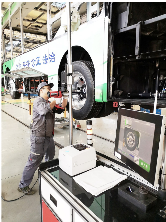
电动巴士生产线工作人员在使用诺霸的扭矩智能系统。
