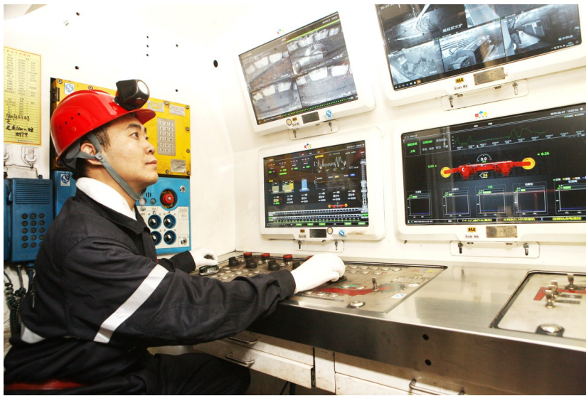
晋能控股煤业集团同忻矿井下集控操作台，只需一键开启工作面便能完成智能开采。
