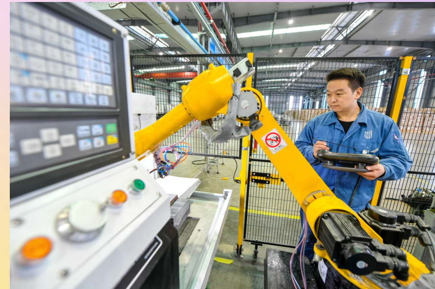
2020年10月9日,位于浙江省湖州市长兴经济技术开发区的浙江华普永明科技有限公司通过机器人和技改升级实现智慧生产,陆续引进全自动铝坯、灯壳内外部毛刺、正反面顶针等机器人单元,助推工业4.0智造升级,实现产能增加80%、人员减少50%,生产的LED户外照明产品畅销长三角市场,并拓展到“一带一路”沿线国家和地区。 人民图片
