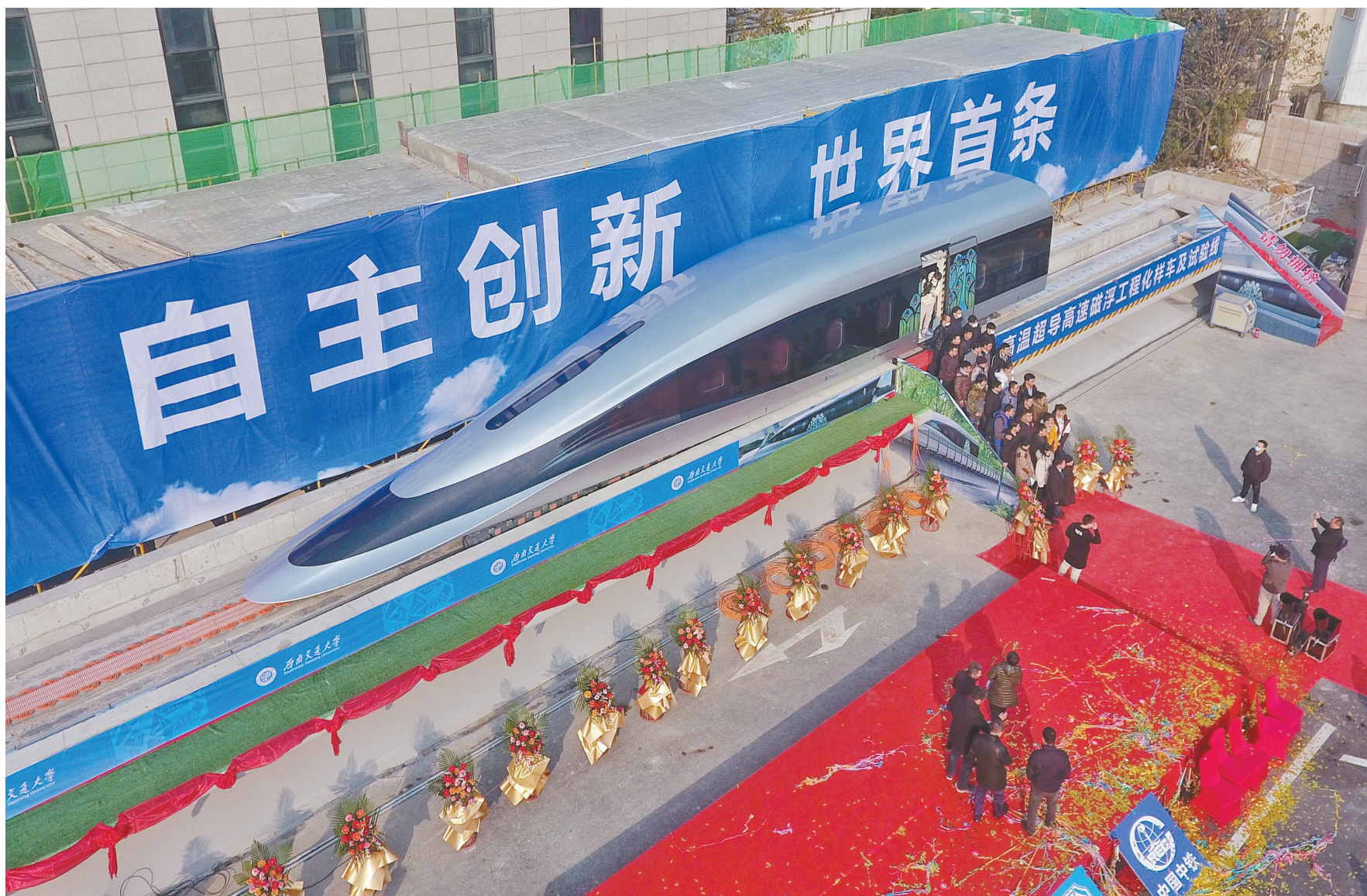
近日,由我国自主研发设计、自主制造的世界首台高温超导高速磁浮工程化样车及试验线正式启用,设计时速620千米,标志着我国高温超导高速磁浮工程化研究实现从无到有的突破。高温超导磁浮技术具有自悬浮、自导向、自稳定特征,适合未来的真空管道交通运输。 新华社记者 刘 坤摄
