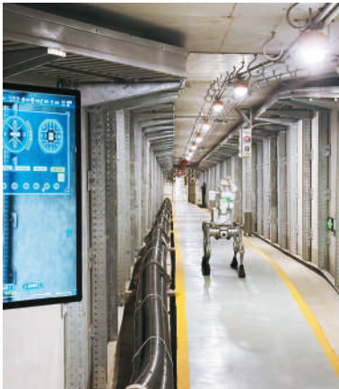
▲四足巡检机器人在河北雄安新区雄东电缆隧道内巡检。 本报记者 叶 子摄
