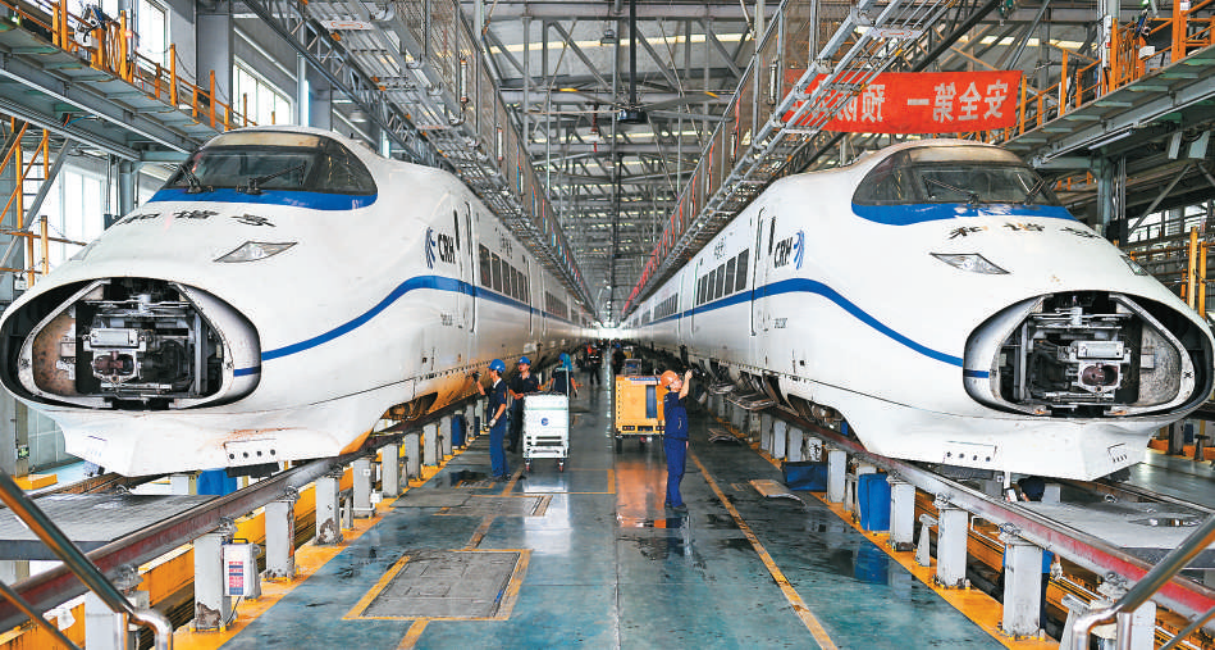
国庆假期临近, 江苏南京动车运用所加大检修保养力度, 对动车制动、受电弓等关键部件细致排查, 全面整治车内设施, 精检细修消除安全隐患, 护航旅客国庆平安出行。图为工作人员在南京动车运用所内检修动车。 方东旭摄 (人民图片)
