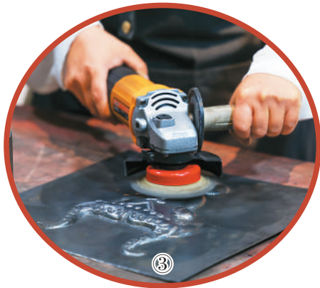
图①—④的铁板浮雕制作 工序依次为：绘制作品手稿、 锤锻塑形、除锈、抛磨。
