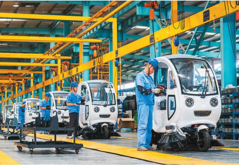
近年来,安徽省芜湖市繁昌经济开发区大力发展新兴产业,加快打造新能源产业集群。图为繁昌经济开发区一家企业总装车间内,工人在组装电动清扫车。肖本祥摄(人民视觉)
