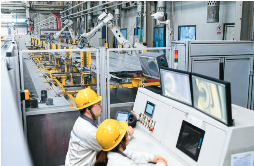
▲在唐车高速动车组铝合金车体数智化生产线上，工人正在进行机器人侧墙打磨作业。本文配图均为受访者提供
