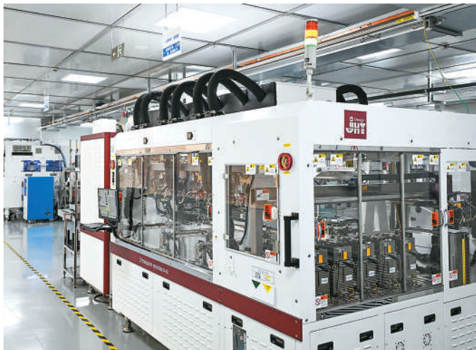
图为张江高科895孵化器的张江芯片测试公共服务平台成品测试车间内，分选设备可用于测试高性能计算、人工智能、系统级芯片。 新华社记者 陈 朔摄
