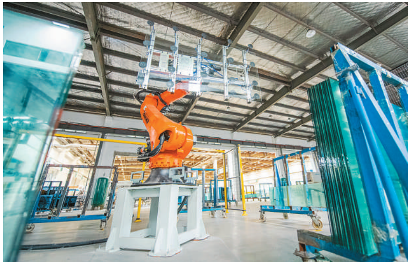
近年来，江苏省宿迁市以智能化、绿色化发展方向，推动传统制造业企业转型升级、提质增效。图为宿迁市宿豫区一家玻璃企业的生产车间内，智能机械手正在码垛玻璃。徐江海摄（人民视觉）
