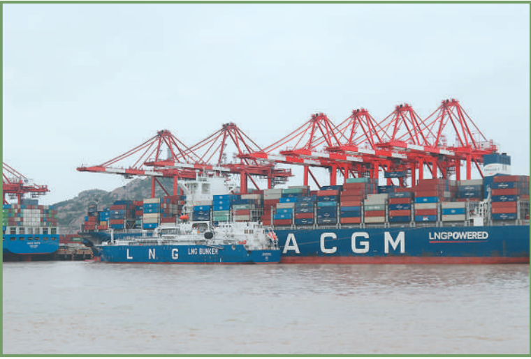
上海洋山港“船对船加注”作业现场。
