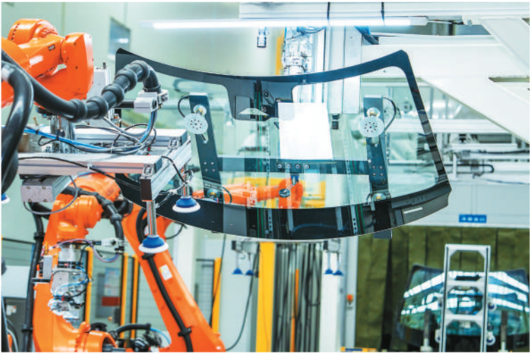
安徽福耀全产业链生产基地汽车玻璃智能工厂里,机械臂将整片玻璃平稳托起。(受访者供图)
