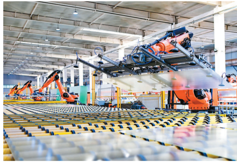
内蒙古自治区鄂尔多斯市准格尔旗大力发展新能源装备制造产业，通过引进光伏玻璃智能生产等高新技术企业，打造新能源装备产业集群，助推区域经济高质量发展。图为准格尔旗一公司的光伏玻璃生产线，智能机械手正在作业。 王 正 摄（人民视觉）
