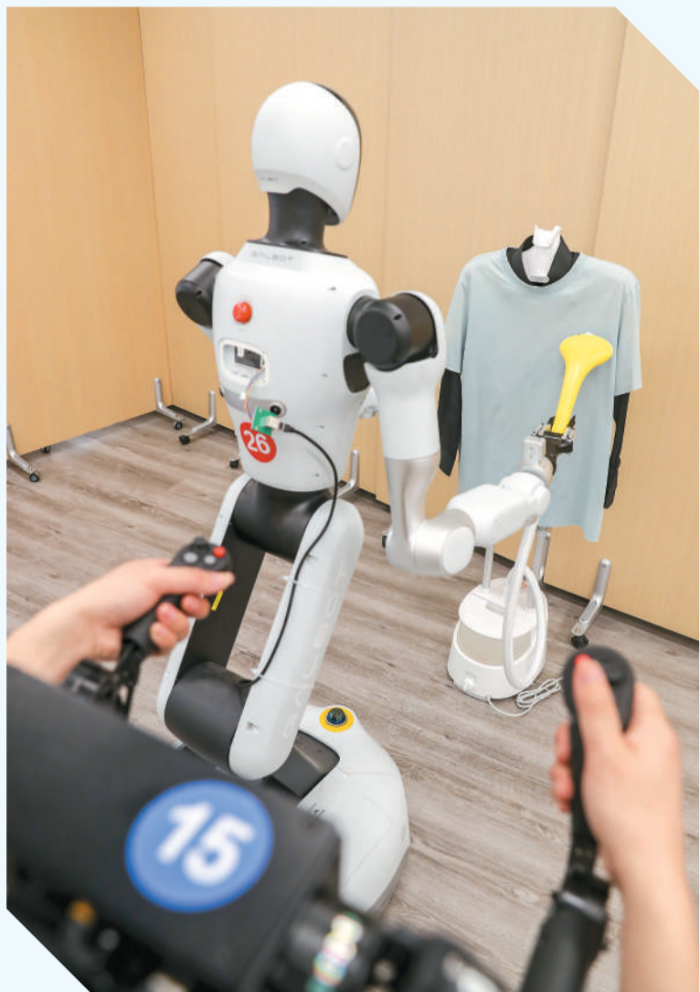
▲ 西南具身智能训练中心位于四川省宜宾市，通过“仿真数据+真机遥操数据”的技术路线，该中心构建起覆盖1万多个物体、30余种人类抓握类型的高质量数据采集体系。图为技术人员在西南具身智能训练中心训练机器人熨烫衣服。 庄歌尔摄（人民视觉）
