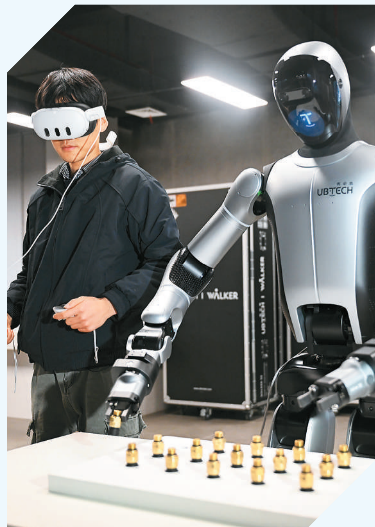
▲ 目前，广西壮族自治区柳州市已培育人工智能终端及机器人规上企业48家。图为柳州机器人产业园内，一位机器人训练师使用手柄与工业人形机器人进行拧螺丝练习。
