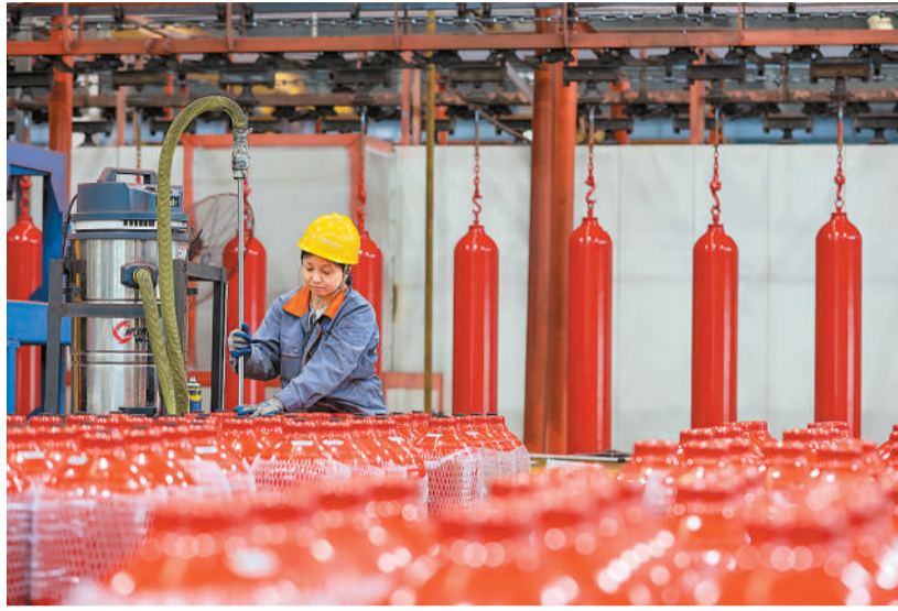
在江西省瑞昌经开区一家企业车间内，工人赶制钢质无缝气瓶产品。 魏东升摄（人民视觉）
