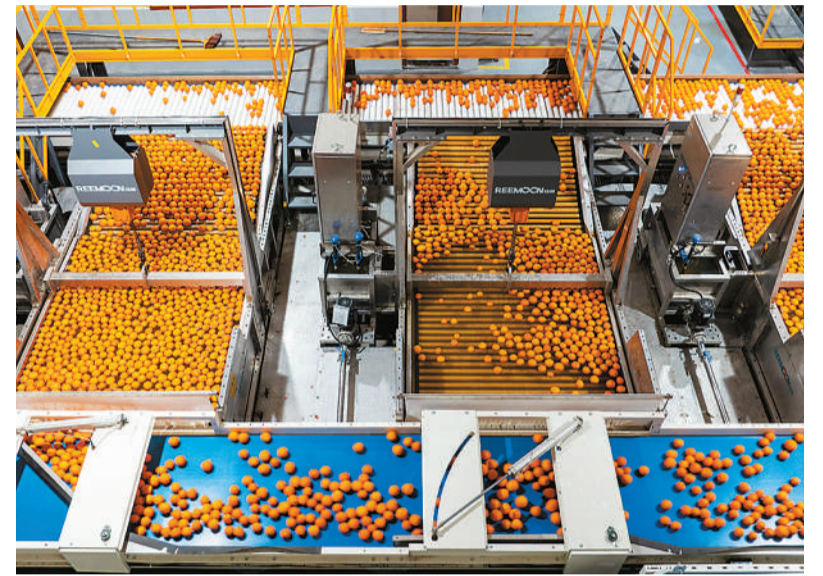
湖北省宜昌市秭归县是脐橙生产大县。眼下，当地的春季脐橙成熟上市，果农利用新技术、新手段采摘、清洗、装运脐橙，有效提高农业生产效率。图为秭归县茅坪镇的一家企业使用配备多功能保鲜定时水槽的分拣线清洗脐橙。 周仕伟摄（人民视觉）
