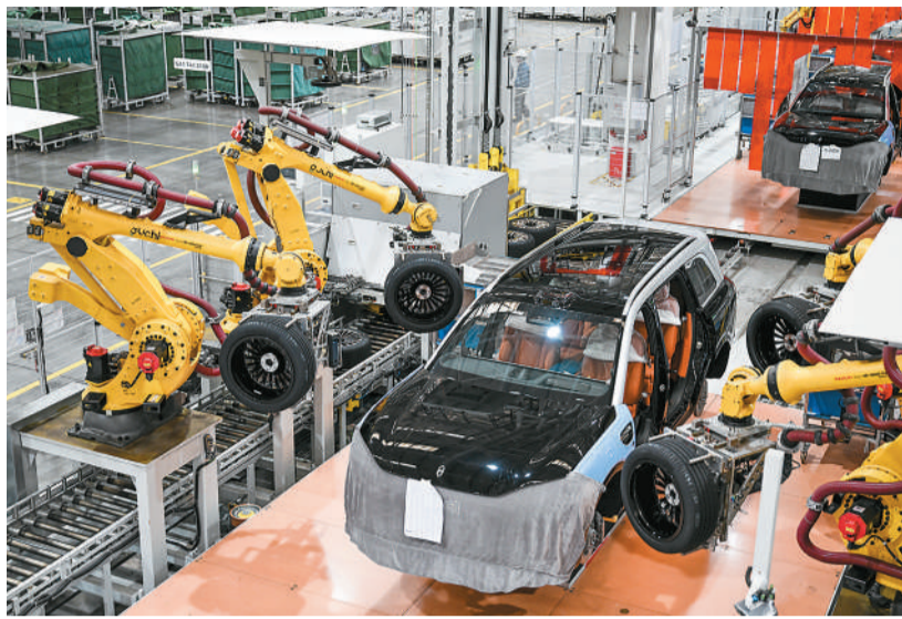
4月2日，位于重庆市两江新区的一家汽车企业工厂内，智能机械臂进行轮胎安装作业。 王加喜摄（人民视觉）
