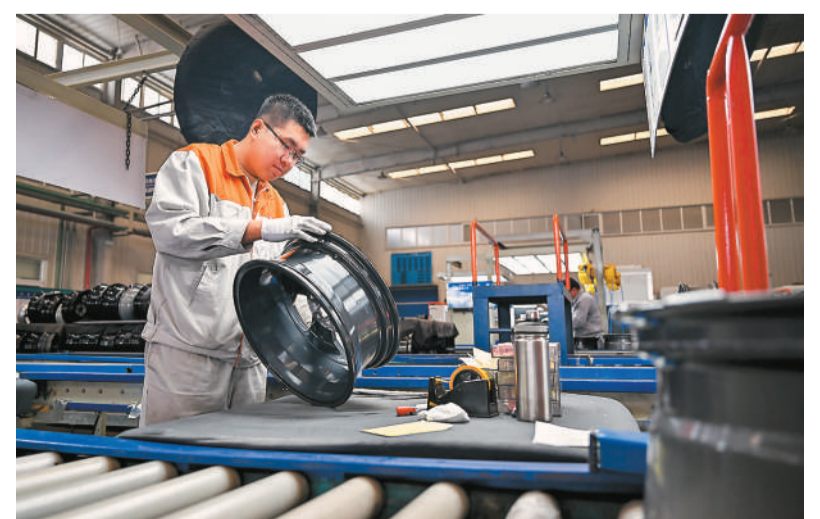
内蒙古自治区包头市立足区位优势，持续推进铝产业发展，着力构建高纯铝、高端铝型材、汽车零部件等高端铝加工产品体系。图为4月1日，工人在包头市一家汽车零部件制造公司铝合金轮毂生产线上作业。 新华社记者 李志鹏摄
