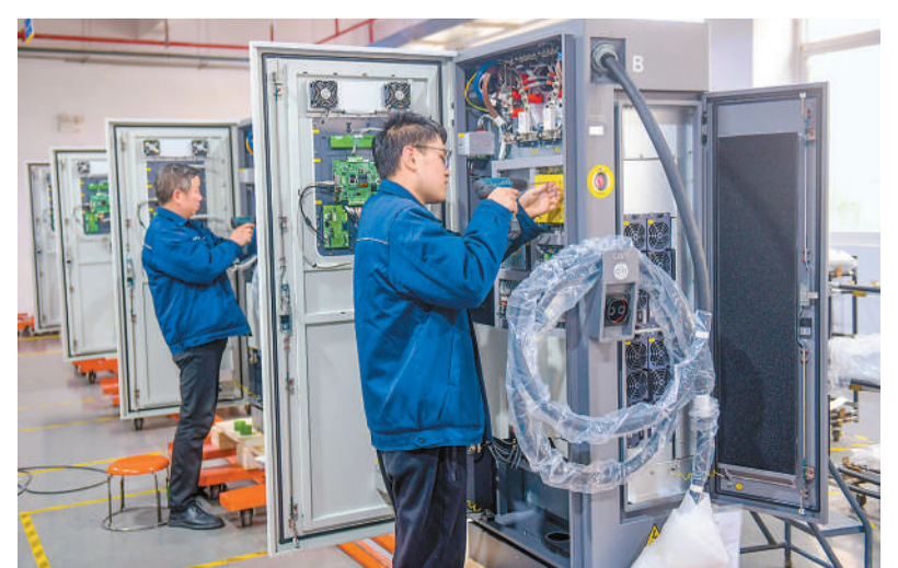
伴随全国新能源汽车保有量持续增长，电动汽车充电桩技术不断成熟，车主充电需求得到更好保障。图为位于河南省洛阳市洛宁县的一家新能源企业车间内，工人在生产电动汽车充电桩。张怡照摄（人民视觉）
