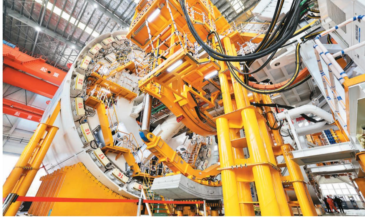
近日，由中国中铁四局集团有限公司、中国中铁隧道局集团有限公司与中国中铁工程装备集团有限公司联合研发，为安徽省马鞍山市湖北路过江通道项目定制的第二台超大直径泥水平衡盾构机“诗城奋进号”在浙江杭州顺利下线。“诗城奋进号”盾构机开挖直径15.07米，掘进推力达2.2万吨，是一台“穿江利器”。图为“诗城奋进号”。
