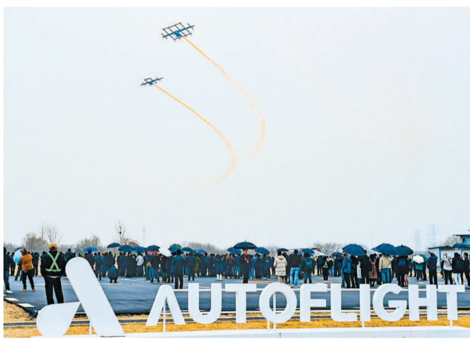
2月5日，中国企业自主研发的5吨级电动垂直起降飞行器（eVTOL）——V5000天际龙在江苏省昆山市民用无人机试飞运行基地圆满完成转换飞行全过程，包括垂直起飞、过渡转换、固定翼巡航和反向转换至平稳着陆，标志着中国企业成功实现目前全球唯一5吨级eVTOL转换飞行。
