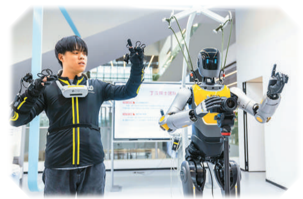
1月19日，湖北武汉光谷湖北人形机器人创新中心内，人形机器人跟着训练师练习拍照动作。
