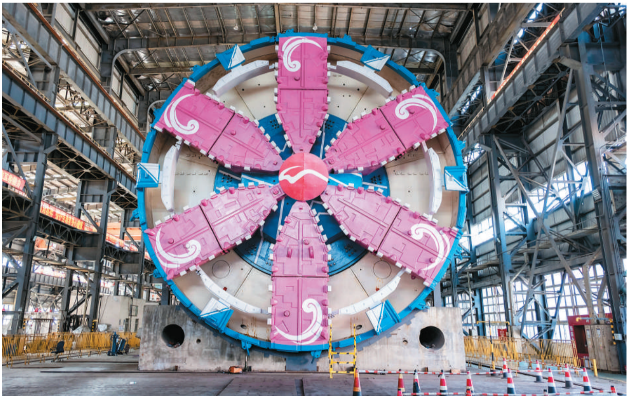
1月9日，江苏无锡至宜兴城际轨道交通工程（锡宜S2线）两台14米级超大直径盾构机分别在上海和湖南长沙同步成功下线。锡宜S2线全长约61公里，其中穿太湖段隧道为工程核心控制性节点，将采用4台14米级泥水平衡盾构机施工，是国内首条穿太湖超大直径盾构隧道。图为当日，“锡望号”盾构机在上海下线。 苏建国摄（新华社发）
