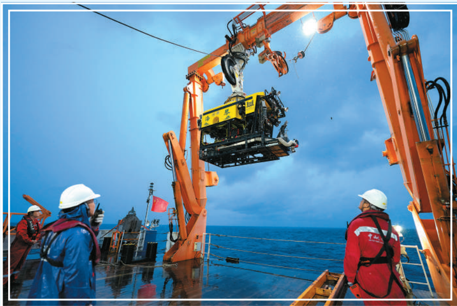
▲今年8月，由上海交通大学水下工程研究所自主研制的“海琴”号潜水器，从4140米深海凯旋。“海琴”号搭载了高清摄像机、多功能机械手、探测传感器等科考设备，具备自动定向、悬停定位、自动巡线等智能作业能力，是深海研究的“科考利器”。图为“海琴”号从海里回收时的情景。 新华社记者 张松建摄
