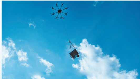
在应急抗灾抢险中,南方电网广西电网公司运用载重无人机精准定位投放应急抢险物资及设备,大大提高抢修效率
