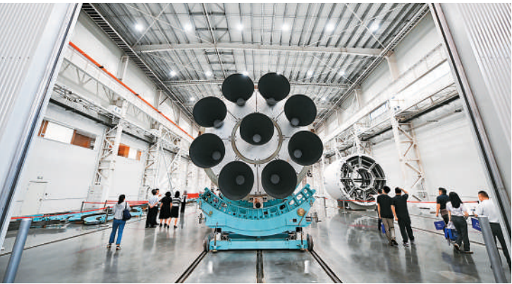
图为星际荣耀运载火箭总装总测复用工厂内设置的双曲线三号运载火箭机械模拟箭。 新华社记者 郭程摄
