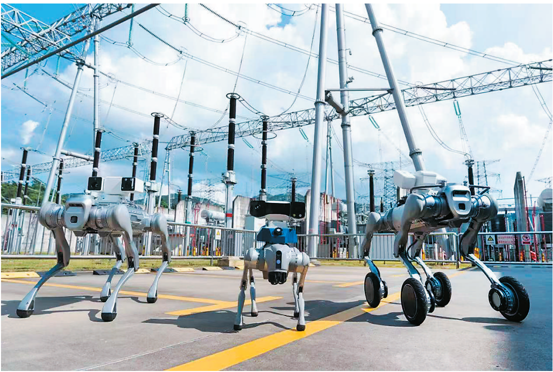
为保障十五运会和残特奥会用电,南方电网深圳供电局运用“AI+机器人”,构建“海陆空”立体化智能巡检体系,推动保供电从“人海战术”向“人机协同”转变。
