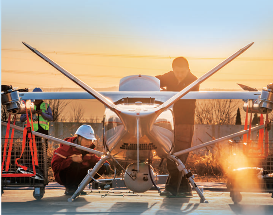
2025年1月，国内首个液氢驱动的电级eVTOL无人飞行器在陕西凤翔高新区成功试飞。图为工作人员正在调试机身。资料图片
