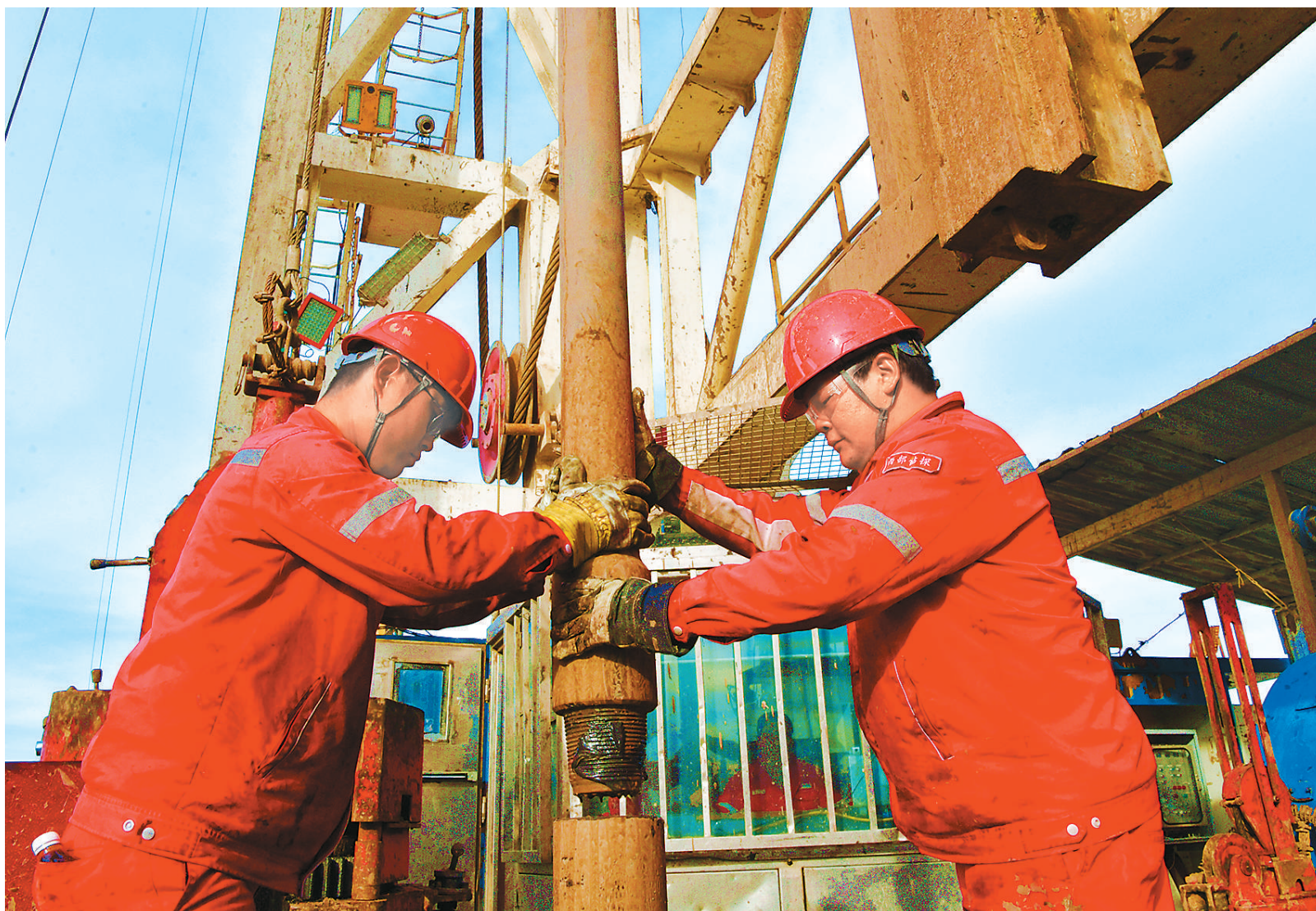
▲ 中国石油西部钻探工程有限公司下属准东钻井公司钻井队石油工人正在沙漠深处忙井场进行下钻施工作业。 周建玲摄（人民视觉）
