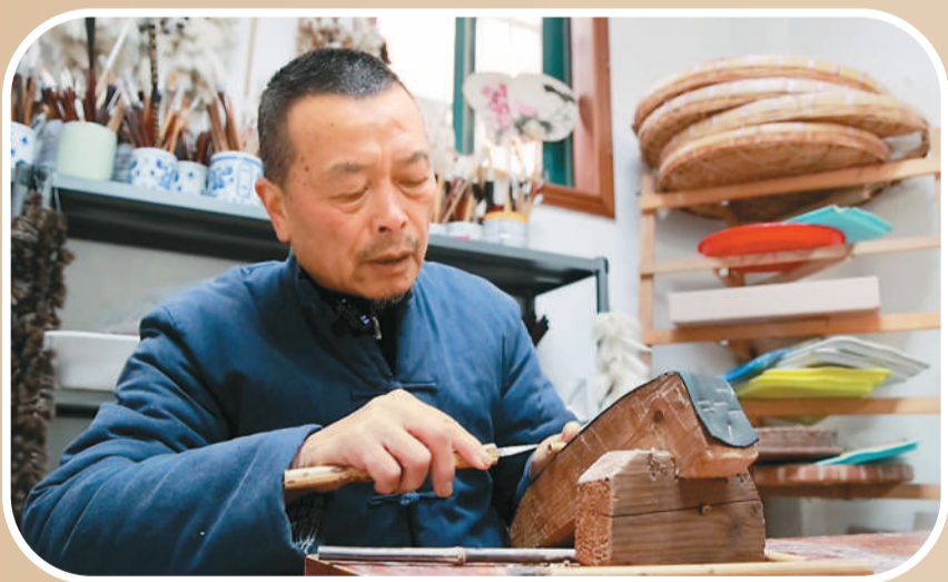
▲ 使用工具将笔杆外部磨平。
