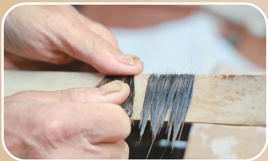
▲ 制作笔头从理毫开始，将毛的根部理齐。然后整理毛的头部，这一步叫齐毫。齐毫后的笔毛变成一片一片的，方便做成圆锥形。图为齐毫。本报记者 丁美栋摄
