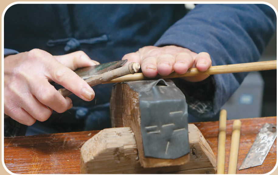
▲ 使用工具将笔杆外部磨平。
