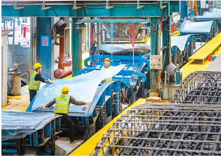
浙江省宁波市持续加强建筑节能研究，积极指导相关企业充分利用河道淤泥、电厂粉煤灰等原材料，加工生产陶粒发泡混凝土墙板、隧道遮板与盾构管片等，实现资源再利用和环境的可持续发展。图为2月10日，位于宁波市宁海县的普利凯建筑科技有限公司工人抢抓开年订单旺季的时机，赶制盾构管片供应市场。
