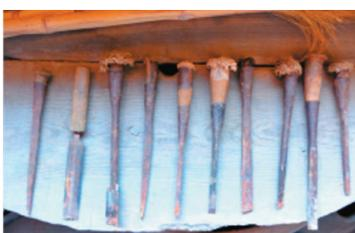
土楼营造工具包括刨、劈、凿、锯、锤等。图为土楼木作凿子、锉刀工具。其中，凿子用来凿眼、挖孔、剔槽，是实现木构件之间榫卯结合的必备工具；锉刀是用来打磨修整木构件的棱角、凹槽、孔眼等不规则表面的工具。
