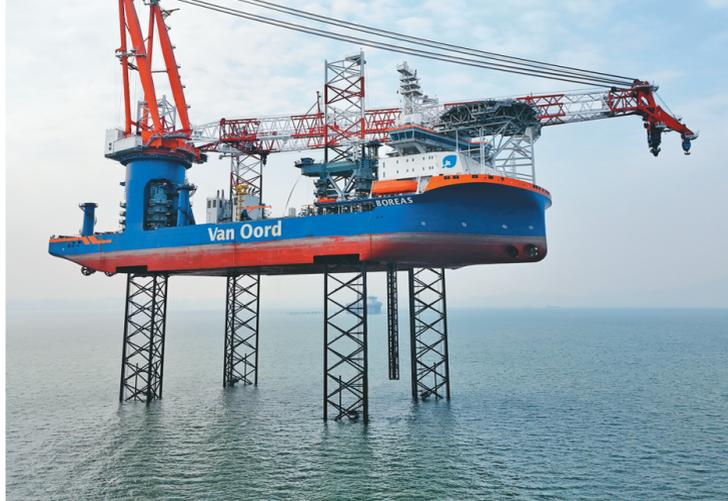
近日，由中集来福士为荷兰公司建造的全球最大、最新一代自升自航式海上风电安装船 BOREAS 号在山东烟台交付。该船甲板面积超过7000平方米，最大工作水深80米，最大升降能力达5.5万吨，能够安装25兆瓦的海上风机。
