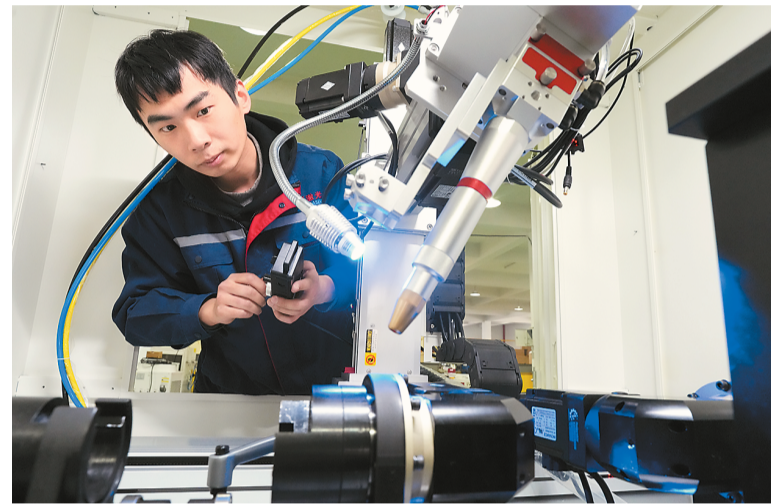
近年来，浙江省绍兴市上虞区积极发展新质生产力，企业创新成效显著，有效助力经济发展。图为1月7日，上虞区浙江创新激光设备有限公司技术人员在调试四轴联动工作台激光焊机。
