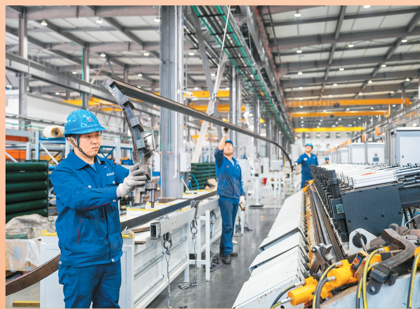
▲ 1月1日，在哈电集团哈尔滨电机厂有限责任公司生产车间，工人正在进行定子线棒模压生产。 新华社记者 张涛摄 ◀ 1月1日，江西省吉安市吉水县上下老街历史文化街区灯火璀璨，游客如织，文旅消费火热。 朱海鹏摄（人民视觉）
