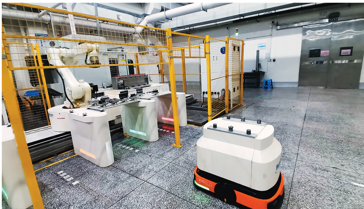
▲图为沃德精密的一处车间内，AGV小车正在和机械手进行物料交接，全程都可实现无人作业。 本报记者 王俊岭摄
