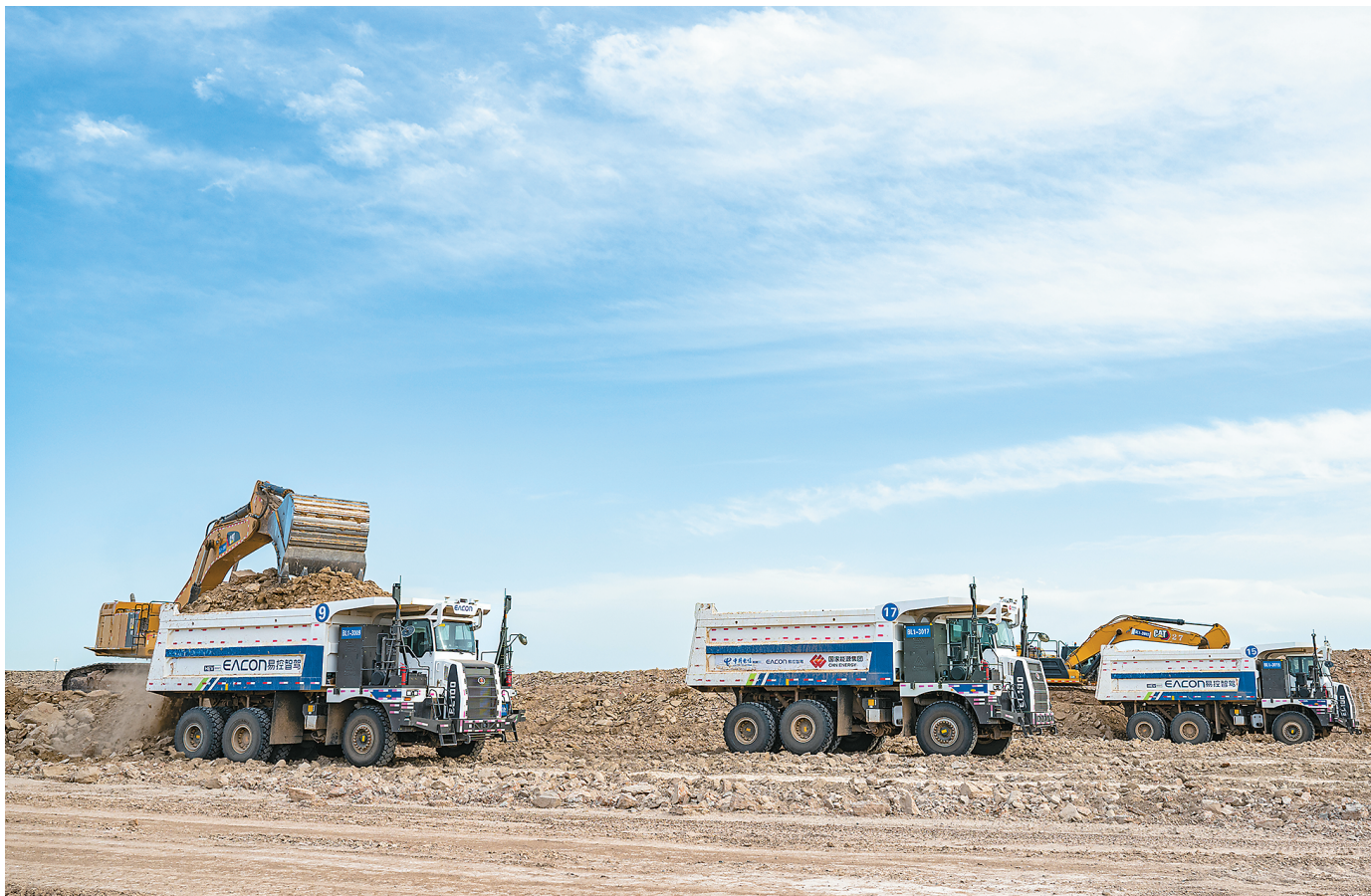
新疆准东经济技术开发区国家能源集团新疆能源有限责任公司准东露天煤矿，无人驾驶矿卡在运送剥离土方。
