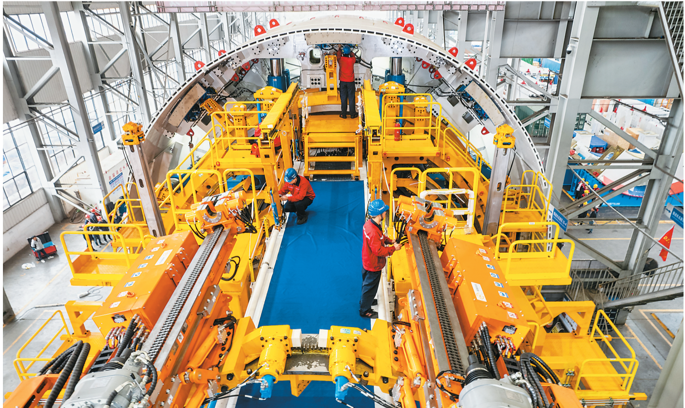
11月22日，由铁建重工、水电六局联合打造的“江汉新石器号”隧道掘进机在长沙下线。据了解，这台掘进机整机长约175米，总重约3000吨，开挖直径达11.93米，将应用于南水北调中线引江补汉工程。图为当日在铁建重工长沙第一产业园，工人在调试“江汉新石器号”隧道掘进机。
