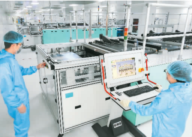
江苏省连云港市海州开发区，工人在查看高效黑硅太阳能电池片生产线运行情况。该项目行业引导性的节能环保配套技术，有效推动当地光伏行业向“高效黑硅电池片+高效晶硅电池片+高效晶硅组件”技术升级。 耿玉和摄（人民视觉）
