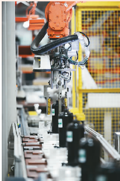
▲海尔空调胶州互联工厂生产线，机器人自动安装空调零件。张进刚 孙国祥摄
