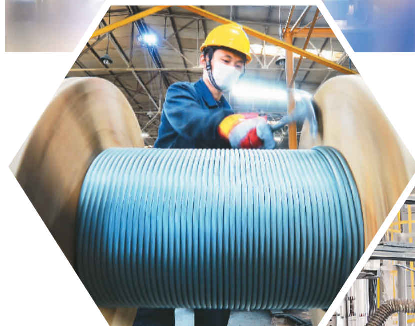
上图：4月21日，一名工人在青岛迪世亚制钢有限公司车间内进行钢丝绳卷取作业。
