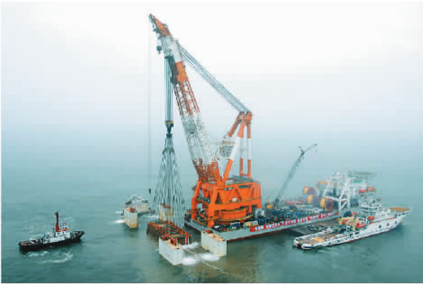
“华天龙”号将沉船整体打捞出水时的壮观场面。这也是“南海Ⅰ号”科考发掘过程中的一个重要节点。（图片来源：广州打捞局网站）
